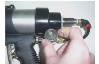
12. Poté nastavte tlak vzduchu tak, abyste dosáhli požadovaného tvaru vytlačované náplně pomocí utahování a povolování regulačních ventilů
