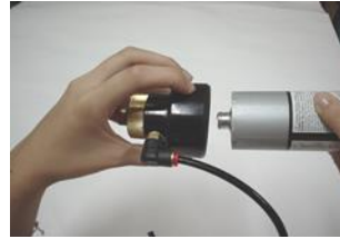
3. Náplň zasuňte do hliníkové press-pistole
