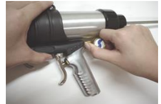
8. Poté nastavte tlak vzduchu tak, abyste dosáhli požadovaného tvaru vytlačované náplně pomocí utahování a povolování regulačních ventilů
