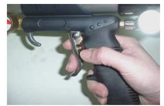
4. Zmáčkněte spoušť pistole a pusťte do ní vzduch. Tím dojde k vytlačení pístu až na okraj hliníkové trubky
