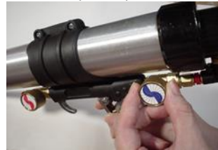
7. Nastavte tlak vzduchu zadního regulačního ventilu a na kus papíru zkuste vytlačit náplň
